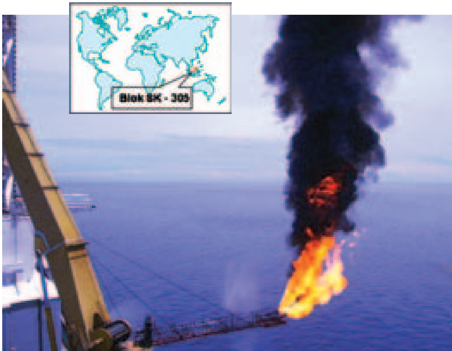
Anjungan lepas pantai di blok SK 305 Serawak Malaysia saat melakukan uji kandungan lapisan yang menunjukkan keberadaan minyak dalam lapisan itu. Menurut rencana pada saat produksi di blok SK 305 akan dicanangkan zero flaring . Target puncak produksi diperkirakan pada tahun 2010 sekitar 20.000 barel per day.
